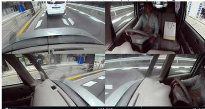
撮影モードは「フロントモード」、より幅広い視野の「ワイドアングルモード」、車内前方と運転席を映す「球面モード」、前後左右を捉える「マルチウィンドウモード」の 4 パターンを搭載する。
